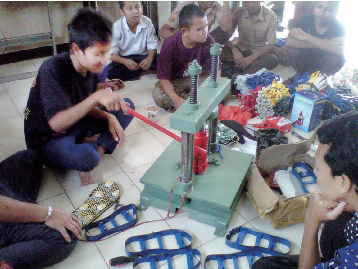
生徒たちがプレス機を使い、材料のスポンジを金型に合わせてビーチサンダルの形にカットする
